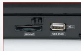
Conexión USB y equipo de lectura de tarjeta integrado
